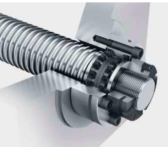
Řada ZKLF v hybridním provedení pro trvalý provoz s krátkým zdvihem: u našich konstrukčních jednotek stačí, když má přípojovací konstrukce frézovaný povrch. Opracování otvoru uložení ložiska není nutné. Ložisková jednotka se při montáži sama vystředí prostřednictvím matice pohybového šroubu.
