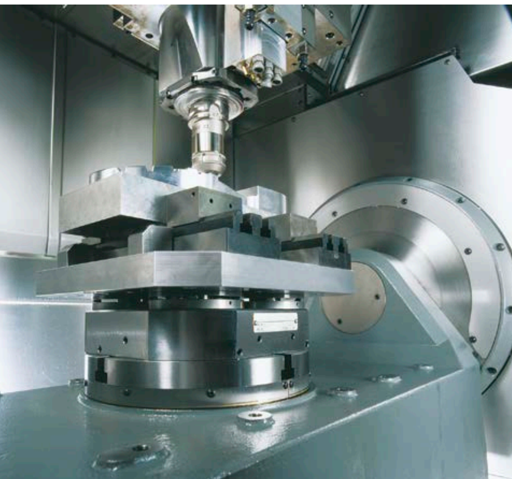
Přesný otočný/naklápěcí stůl s maximální provozní výkonností díky ložiskovým řešením INA/FAG
