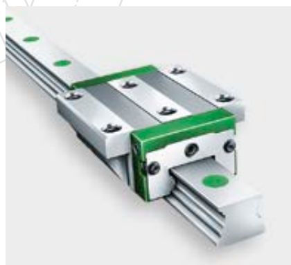
Kompaktní řešení: čtyřřadé kuličkové profilové lineární vedení KUVE nabízí kombinaci nejvyšší zatížitelnosti a tuhosti s vysokou dynamikou
