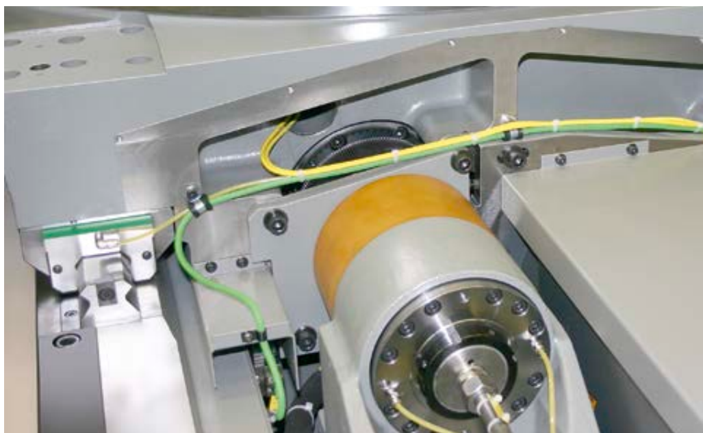
Válečkové profilové lineární vedení řady RUE zajistí spolehlivé uložení hlavních os obráběcích strojů
