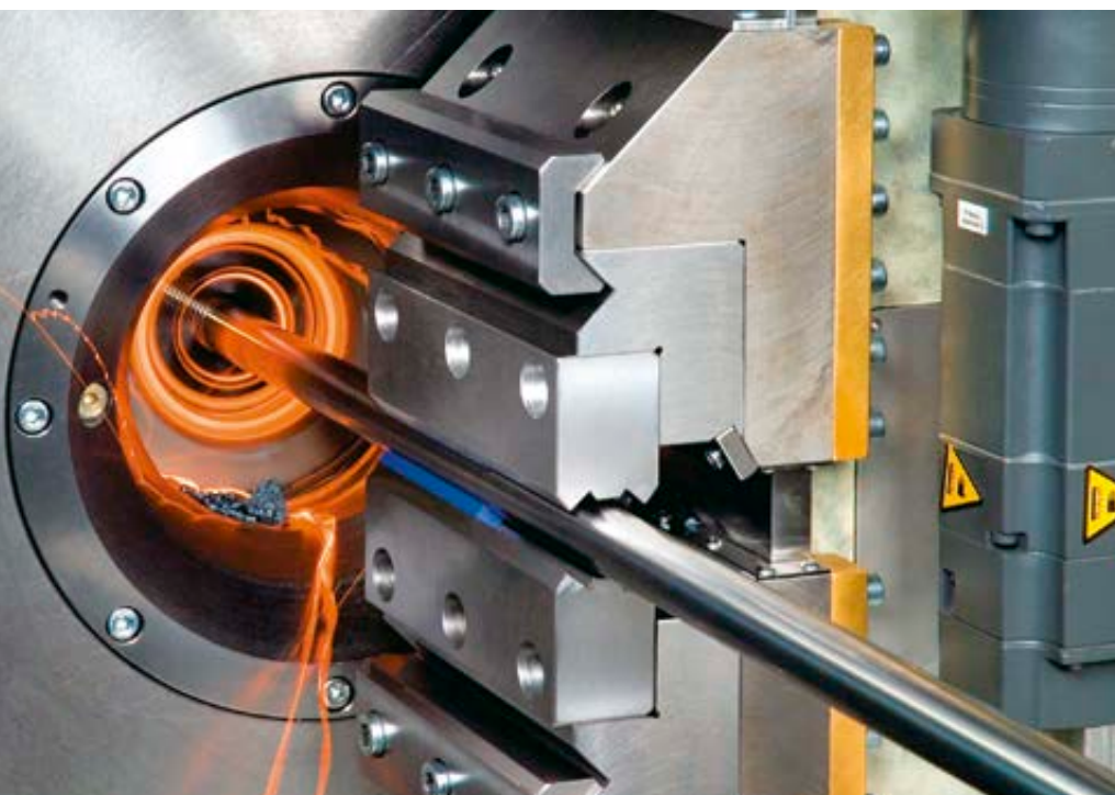
Stroj na okružovací frézování závitů s momentovým motorem (typu RI)
